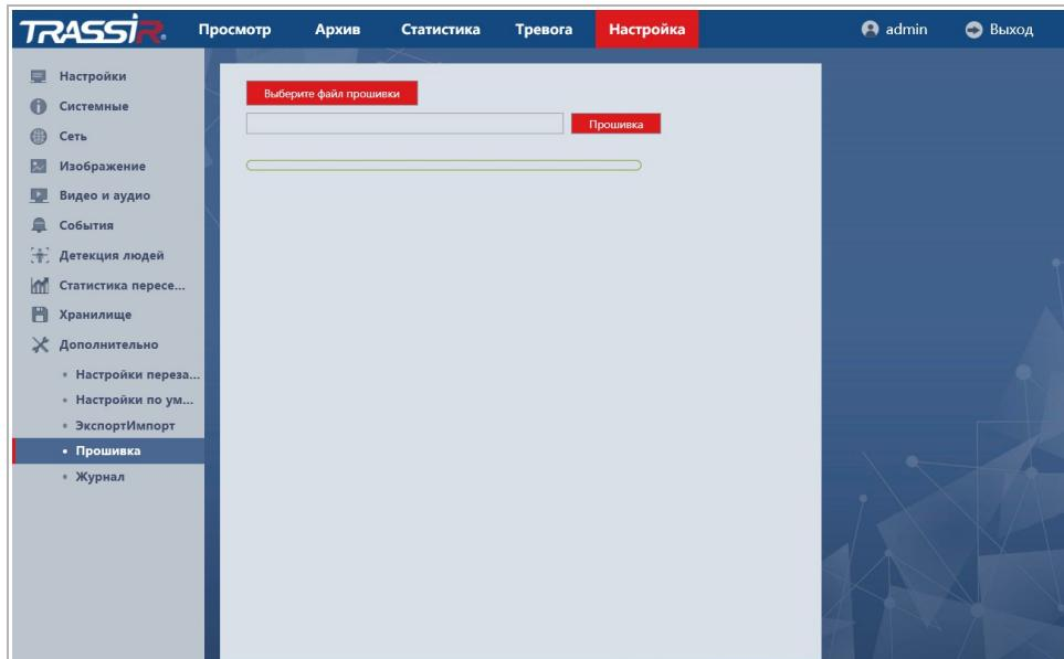
Для обновления программного обеспечения (прошивки) IP-камеры нажмите кнопку **Выберите файл прошивки [Browse]** и укажите файл с программным обеспечением. Чтобы начать загрузку файла нажмите кнопку **Прошивка [Upgrade]**.
