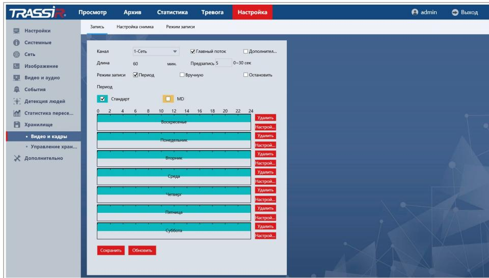
В поле **Канал [Channel]** выберите канал, для которого будет производиться настройка.
