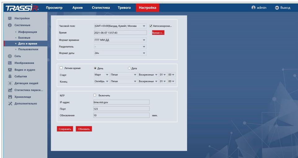
В первом блоке отображены дата и время установленные на IP-камере. Изменяя значение в настройке **Часовой пояс [Time zone]** вы можете выбрать временную зону, в которой работает IP-камера.
