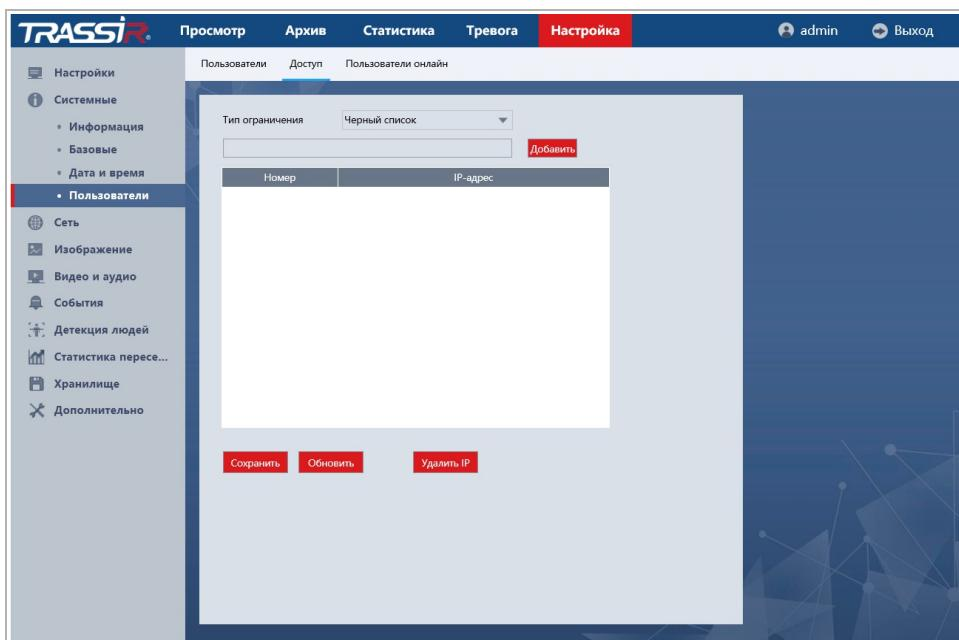
Используя настройки фильтра по IP можно ограничить доступ к IP-камере с одного или нескольких сетевых устройств.
